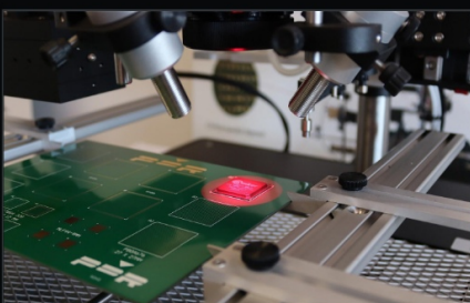
FOKUSSIERTE INFRAROTSTRAHLUNG | GEZIELTE BAUTEILERWÄRMUNG
