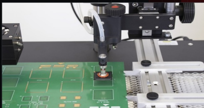
EXTRACCIÓN + COLOCACIÓN AUTOMATIZADAS
