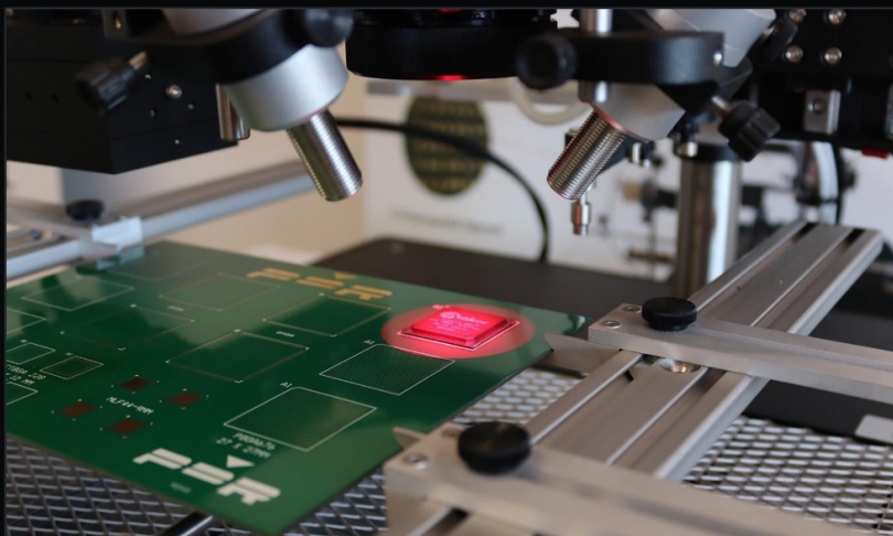
INFRARROJOS FOCALIZADOS | CALENTAMIENTO DIRIGIDO DEL COMPONENTE
