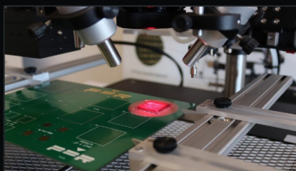
INFRARROJOS FOCALIZADOS | CALENTAMIENTO DIRIGIDO DEL COMPONENTE
