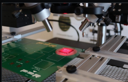
INFRAROUGE FOCALISÉ | CHAUFFAGE CIBLÉ DU COMPOSANT
