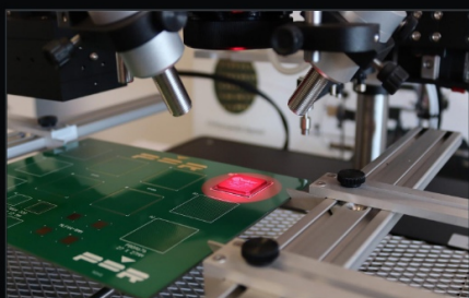
INFRAROUGE FOCALISÉ | CHAUFFAGE CIBLÉ DU COMPOSANT
